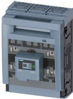
SENTRON, Sicherungslasttrennschalter 3NP1, 3-polig, NH2, 400 A, für Aufbau und Einbau auf Montageplatte, Rahmenklemme, Sicherungsüberwachung: elektronisch EFM20, Abdeckebene 70mm
