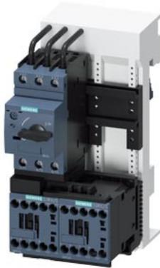
Verbraucherabzweig sicherungslos, Reversierbetrieb AC 400 V, Baugröße S00 0,90...1,25 A DC 24 V Schraubanschluss für 60 mm Sammelschienen-systeme (erfüllt auch Zuordnungsart 1) Zuordnungsart 2, I<sub>q</sub> = 150 kA 1Ö (Schütz)
