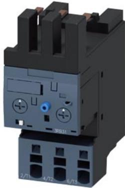
Überlastrelais 1...4 A elektronisch für Motorschutz Baugröße S0, CLASS 5...30 Schützenbau Hauptstromkreis: Federzugklemme Hilfsstromkreis: Federzugklemme Hand-Automatik-RESET interne Erdschlusserkennung
