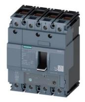
Leistungsschalter 3VA1 IEC Frame 160 Schaltvermögenklasse H Icu=70kA @ 415V 4-polig, Anlagenschutz TM240, ATAM, In=16A Überlastschutz Ir=11A...16A Kurzschlussschutz Ii=10...20 x In N-Leiter ungeschützt Klemmenanschluss
