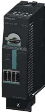
DS1E-X für ET200S High Feature Direktstarter Einstellbereich 2,4...16 A mechanisch schaltend elektronisch Schützen AC-3, bis 7,5 kW / 400 V erweiterbar für Brake Control Modul 2DI Modul 2DI Modul Motorstarter ES Leistungsschaltermeldung parametrierbar DPV 1 fähig PROFIENERGY fähig an PN
