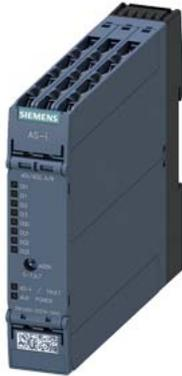
AS-i SlimLine Compact Modul SC22.5 digital, A/B-Slave 4DI/4DQ, IP20 4 x Eingang für 3-Leiter Sensor Sensorversorgung umschaltbar 4 x Ausgang, 2 A, DC 24 V maximal 4 A für alle Ausgänge Schraubklemmen Baubreite 22,5 mm
