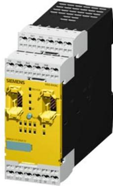
SIRIUS, Zentralmodul 3RK3 Basic für modulares Sicherheitssystem 3RK3 4/8 F-DI, 1F-RO, 1 F-DO, DC 24 V parametrierbar mit SW Safety ES 45 mm Baubreite Federzugklemme bis SIL3 (IEC 61508) bis Performance Level E (ISO 13849-1)
