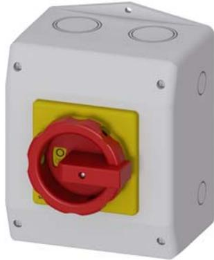
SETRON, Lasttrennschalter 3LD, Not-Aus-Schalter, 6- polig, Iu: 25 A, Betriebsleistung / bei AC-23 A bei 400V: 9,5 kW, Isolierstoff- Kapselung für metrische Verschraubung, 1Ö, 1S, Drehantrieb, rot/gelb
