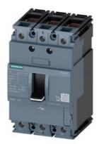
Leistungsschalter 3VA1 IEC Frame 160 Schaltvermögenklasse M Icu=55kA @ 415V 3-polig, Starterschutz TM110M, FM, In=1A ohne Überlastschutz Kurzschlussschutz Ii=15 x In Klemmenanschluss
