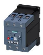
Überlastrelais 80...100 A thermisch für Motorschutz Baugröße S3, CLASS 10 Einzelaufstellung Hauptstromkreis: Schraub Hilfsstromkreis: Schraub Hand-Automatik-RESET
