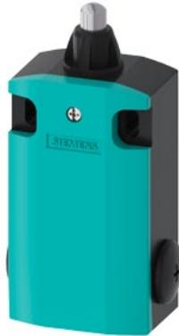
Positionsschalter Metallgehäuse XL, 56 mm breit mit Kuppenstößel, aus Edelstahl mit 3 mm Überhub Geräteanschluss 3 x (M20 x 1,5), 1 x (1S/1Ö) Schleichschaltglied und 1 x (1S/2Ö) Schleichschaltglied mit Überschneidung, IP66/IP67
