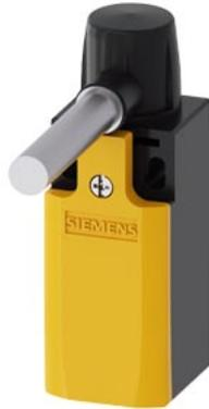
Scharnierschalter Metallgehäuse, 31mm, EN 50047 Geräteanschluss 1 x (M20 x 1,5) Sprungschaltglieder 2Ö/1S integriert, mit Vollwelle Durchmesser = 10 mm Schaltwinkel 10°
