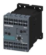
Zeitrelais, elektronisch Multifunktion, 8 Funktionen 1 Wechsler AC/DC 24 V, AC 100 bis 127 V bei AC 50/60 Hz 0,05 s bis 100 h Baubreite 45 mm Federzugklemme
