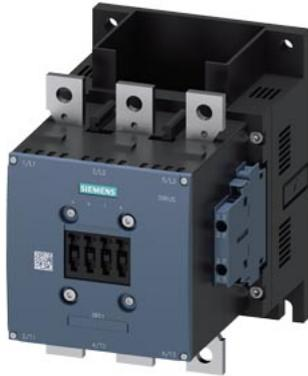
Leistungsschütz, AC-3 265 A, 132 kW / 400 V ohne Spule Hilfskontakte 2 NO + 2 NC 3-polig, Baugröße S10 Hauptleiter: Schienenanschlüsse Antrieb: konventionell Hilfsleiter: Schraubanschlüsse
