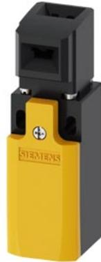
Sicherheits-Positionsschalter mit getrenntem Betätiger Kunststoffgehäuse, 31 mm Geräteanschluss 1x (M20x 1,5) Schleifschiene 2Ö/1S, 5 Anfahrrichtungen, der dazu passende getrennte Betätiger 3SE5000-0AV0 muss separat bestellt werden
