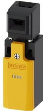
Sicherheits-Positionsschalter mit getrenntem Betätiger Kunststoffgehäuse, 31 mm Geräteanschluss 1x (M20x 1,5) Schleichschaltglieder 1S/1Ö 2x LEDs gelb/grün AC 230 V 5 Anfahrrichtungen der dazu passende getrennte Betätiger 3SE5000-0AV0. muss separat bestellt werden
