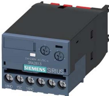
Elektronisch zeitverzögerter Hilfsschalter ansprechverzögert Relais 1 Wechsler AC/DC 24...240 V Zeitbereich 0,05...100 s frontseitig aufschraubbar für Schütze 3RT2 S00-S3 und Hilfsschütze 3RH2 S00 Schraubanschluss Varistor zur Bedämpfung der Schützspulen integriert
