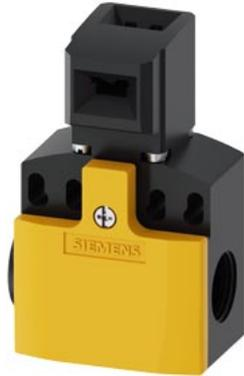
Sicherheits-Positionsschalter mit getrenntem Betätiger Kunststoffgehäuse, 50 mm Geräteanschluss 2x (M20x 1,5) Schleichschaltglieder 1S+2Ö 5 Anfahrrichtungen der dazu passende getrennte Betätiger 3SE5000-0AV0. muss separat bestellt werden
