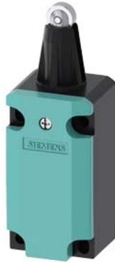
Positionsschalter Metallgehäuse 40 mm nach DIN EN 50041 Rollenstößel mit Edelstahlrolle 13 mm, 3 mm Überhub, 1S/1Ö Sprungkontakte, Geräteanschluss 1x (M20 x 1,5), Betätigungs-/Rückstellkraft 30N nur als Komplettgerät lieferbar
