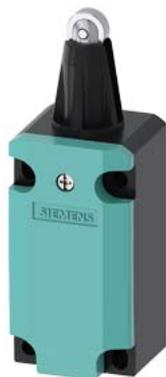
Positionsschalter mit Rollenstößel, Metall, 40 mm, nach EN 50041 erhöhter Korrosionsschutz Geräteanschluss 1 x (M20 x 1,5) 1S/2Ö Sprungkontakte funktionsfähig bei -40 °C Schock- und Schwingprüfung nach DIN EN 61373, Kategorie 1B
