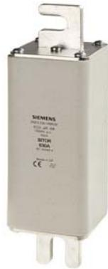
SITOR-Sicherungseinsatz, mit geschlitzten Messerkontakten, NH2, In: 200 A, aR, Un AC: 1500 V, Un DC: 1000 V, ohne Kennmelder
