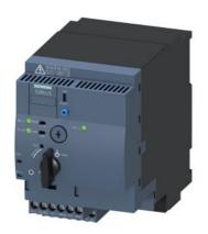
SIRIUS Kompaktabzweig Wendestarter 400 V AC/DC 110...240 V 50...60 Hz 8...32 A IP20 Anschluss Hauptstromkreis: steckbar, ohne Klemmen Anschluss Steuerstromkreis: Schraubanschluss
