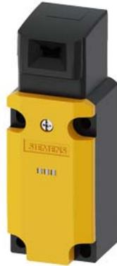
Sicherheits-Positionsschalter mit getrenntem Betätiger Metallgehäuse, 40 mm Geräteanschluss 1x (M20 x 1,5) Schleifschiene mit 2 LEDs, AC 230 V gelb/grün 5 Anfahrrichtungen der dazu passende getrennte Betätiger 3SE5000-0AV0. muss separat bestellt werden
