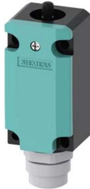
Basisschalter für Positionsschalter 3SE51 Metallgehäuse 40 mm nach DIN EN 50041 1S/2Ö Sprungkontakte mit Stecker 6+PE nach EN 43651 Kunststoff, maximal 250 V, 6 A ohne Antriebskopf Pin-Belegung: Pin1=21, Pin2=22 Pin3=13, Pin4=14, Pin5=31 Pin6=32 und PE angeschlossen
