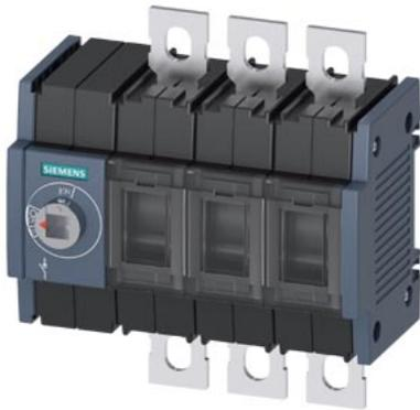
Lasttrennschalter 100A, Baugr. 2, 3-polig Frontantrieb links Grundgerät ohne Handgriff Flachanschluss inkl. Phasentrennwänden
