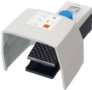
Sicherheits-Fußtaster 1-pedalig, mit Schutzhaube, IP65, mit Verriegelungsfunktion, 2S+2Ö, Schließer, schließt als Taster, Öffner, öffnet mit gleichzeitiger Rastung ( Sicherheitsfunktion), Leitungseiführung M20 x 1,5
