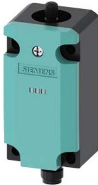
Basisschalter 3SE51, Metallgehäuse 40 mm nach EN 50041, 1S/2Ö Sprungkontakte mit M12-Stecker, 8-polig Metall ohne Antriebskopf Pin-Belegung: Pin1=21, Pin2=22 Pin3=13 und LED grün, Pin4=14 und LED gelb, Pin5=31, Pin6=32 Pin 7=Masse LED, Pin 8=PE
