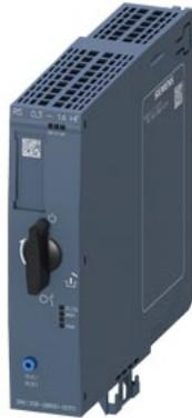
Wendestarter High Feature; elektronisch schaltend; elektronischer Überlastschutz bis 0,25kW / 400V; Einstellbereich 0,3 .. 1A; PROFlenergy; Option: 3DI/LC-Modul
