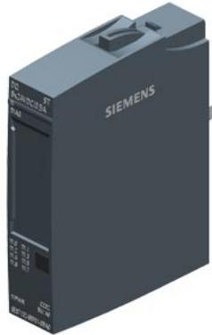
SIMATIC ET 200SP, Digitales Ausgangsmodul, DQ 8x 24V DC/0,5A Standard, Source Output (PNP,P-schaltend) Verpackungseinheit: 1 Stück, passend für BU-Typ A0, Farbcode CC02, Ersatzwertausgabe, Modul-Diagnose für: Kurzschluss nach L+ und M, Drahtbruch, Versorgungsspannung
