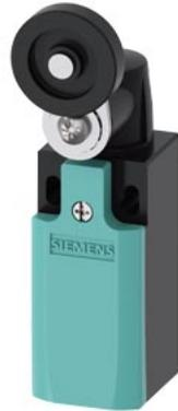
Positionsschalter Kunststoffgehäuse nach DIN EN 50047, 31 mm Geräteanschluss 1 x (M20 x 1,5) 1S/1Ö Sprungkontakte integriert (nicht austauschbar) Schwenkhebel, 21 mm lang rechts/links einstellbar mit Kunststoffrolle 30 mm
