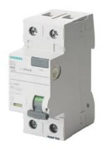
FI-Schutzschalter, 2-polig, Typ F, selektiv, In: 80 A, 300 mA, Un AC: 230 V
