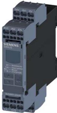
Digitales Überwachungsrelais Drehzahlüberwachung für IO-Link von 0.1...2200 U/min Über- und Unterschreitung Anlaufverzögerungszeit Auslöseverzögerungszeit Hysterese 0.1 bis 99 U/min 1 Wechsler, Federzugtechnik
