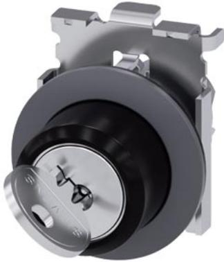
Schlüsselschalter RONIS, 30 mm, rund, Metall, matt, Frontring für flachen Einbau, Schließ-Nr. SB30, mit 2 Schlüsseln, 2 Schaltstellungen O-I, verrastend, Schaltwinkel 90°, 10:30h/13:30h, Schlüsselabzug I, mögliche Sonderschließungen: SB31, 421, 455
