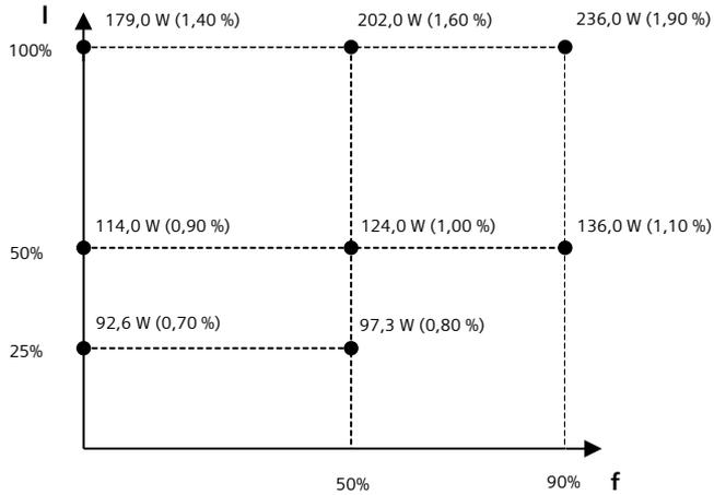
Die Prozentwerte geben die Verluste in Bezug auf die Bemessungscheinleistung des Umrichters an.
