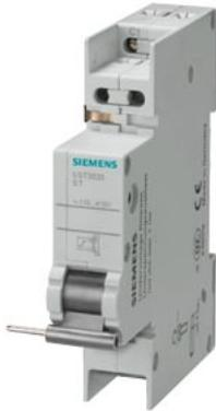
Arbeitsstromauslöser AC 110-415V, für LS-Schalter 5SL4, 5SY, 5SP, FI/LS 5SU1, FI 5SV (bei 5SU1 ist Griffverbinder 5ST3805-1 erforderlich)
