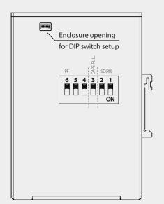
**Power Fail:** relay contact 3+4=0  $\Omega$  0.5 A@ 125 VAC / 1 A@ 24 VDC
