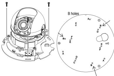
The C Screw Holes: FD8131V / FD8133V / FD8134V
