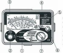
**\*\*DMETER MOVEMENT ZERO ADJUST @TEST BUTTON** (3)SCALE PLATE **4**INPUT CONNECTOR **⑤LIVE CIRCUIT LAMP 6**OHMS ZERO ADJUST **PRANGE SELECTOR SWITCH**
