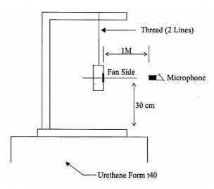
1 METER FROM MICROPHONE TO FAN INTAKE
