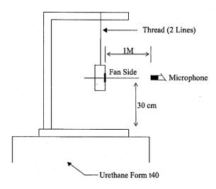
1 METER FROM MICROPHONE TO FAN INTAKE
