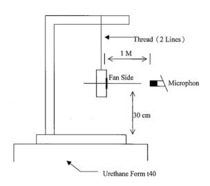
1 METER FROM MICROPHONE TO FAN INTAKE
