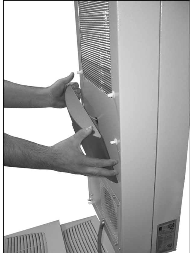
Fig. 37: Remove the infill panel
