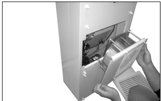
Fig. 64: Remove the external circuit fan
