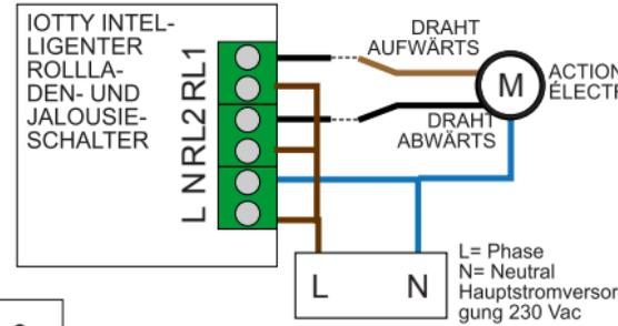
Der Eingang L / N sollte an einen 16-A-Leistungsschalter angeschlossen werden, und jeder Ausgang sollte vor der Verwendung an einen 5-A-Leistungsschalter angeschlossen werden.
