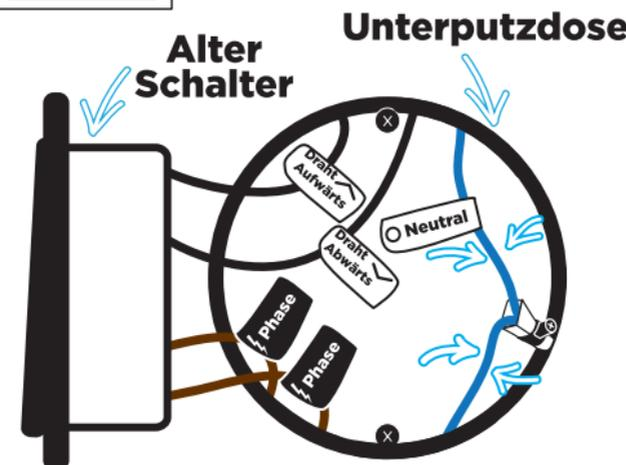
Entfernen Sie Ihren alten Schalter und beschriften Sie die Drähte. Denken Sie daran, dass Sie einen Neutralleiter benötigen, um den intelligenten iotty Rolladen- und Jalousieschalter zu installieren.
