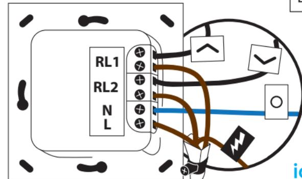
Stecken Sie den Neutralleiter in die mit N gekennzeichnete Schraubklemme. Stecken Sie die Phase in die Schraubklemme L und in eine Schraubklemme von RL1 und eine von RL2. Stecken Sie den Aufwärtsfunktionsdraht in die freie Schraubklemme von RL1. Stecken Sie den Abwärtsfunktionsdraht in die freie Schraubklemme von RL2. Wenn Sie ein Erdungskabel haben, legen Sie es in die Wanddose.
