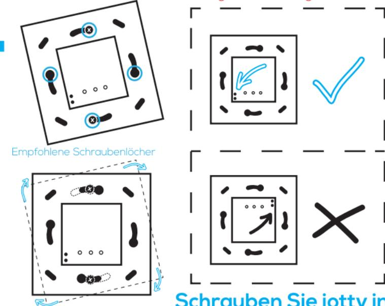
Schieben Sie alle Drähte zurück in die Unterputzdose und versuchen Sie so viel Platz wie möglich für den Schalter zu lassen. (Schieben Sie die Drähte nicht über die Rückseite des Schalters.) Setzen Sie den iotty Rolladen- und Jalousieschalter in die Schrauben der Unterputzdose ein. Stellen Sie den Schalter so ein, dass sich die Knöpfe unten befinden.
