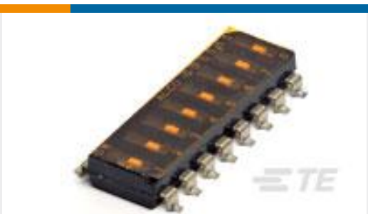
TE Part #1825006-5 GDS0404=DIP SW,SLIDE,THRU/HL
