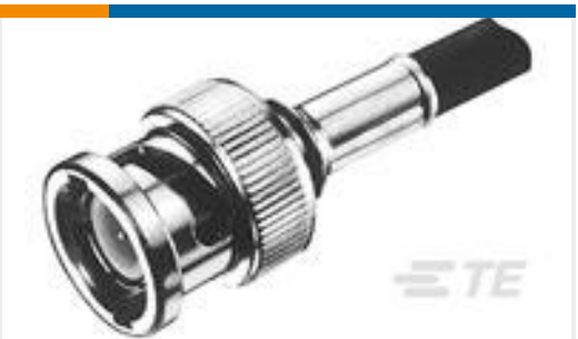
TE Part #1-1337427-0 BNC Str Plg Hex 50Ohm Silver P
