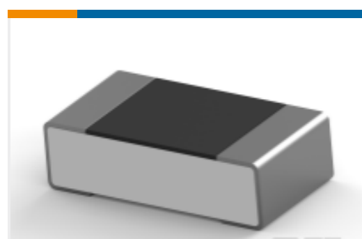
TE Part #3-2176367-7 RQ 0603 11K 0.1% 10PPM 1K RL
