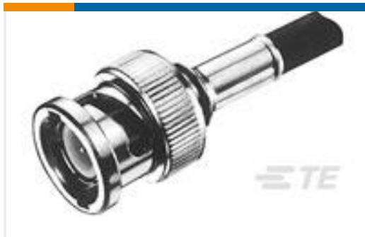
TE Part #1-1337431-0 BNC Str Plg Hex 75Ohm Nickel Pltd RG179B
