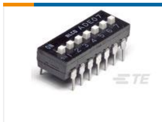
TE Part #1825057-3 ADE040=DIP SWITCH,EXT,THRU/HL
