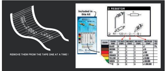
DO NOT BLINDLY FOLLOW THE ORDER OF THE COMPONENTS ONTO THE TAPE. ALWAYS CHECK THEIR VALUE ON THE PARTS LIST!
