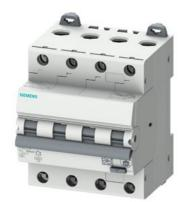
RCBO, 6 kA, 4P Type A, 300mA, B-Char, In: 10A Un: 400V
